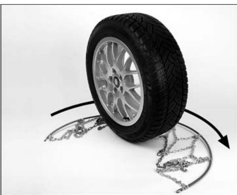
Kette am Laufnetz erfassen und Seilring rüttelnd über die Lauffläche ziehen, bis die Verschlußteile sichtbar sind. Verschlußteile (wie Bildausschnitt) aushängen...
