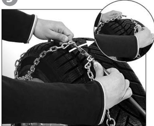
Verschlußteile (wie Bildausschnitt) einhängen und geschlossenen Seilring auf die Reifenlauffläche legen.
