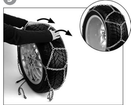
Seilring über die Lauffläche schieben (Bild zeigt Zwischenstellung)... bis der Seilring in der Mitte der Reifenflanke zu liegen kommt (wie Bildausschnitt).
