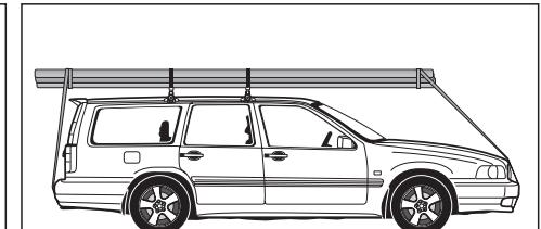
**S VIKTIGT!** Spän enbart fast lasten mellan vänster och höger laststopp. Ej mellan främre och bakre. Om lång last förekommer skall den även spännas fast fram- och baktill på bilen. Kontrollera att lasten inte kan förflyttas i färdriktning.
